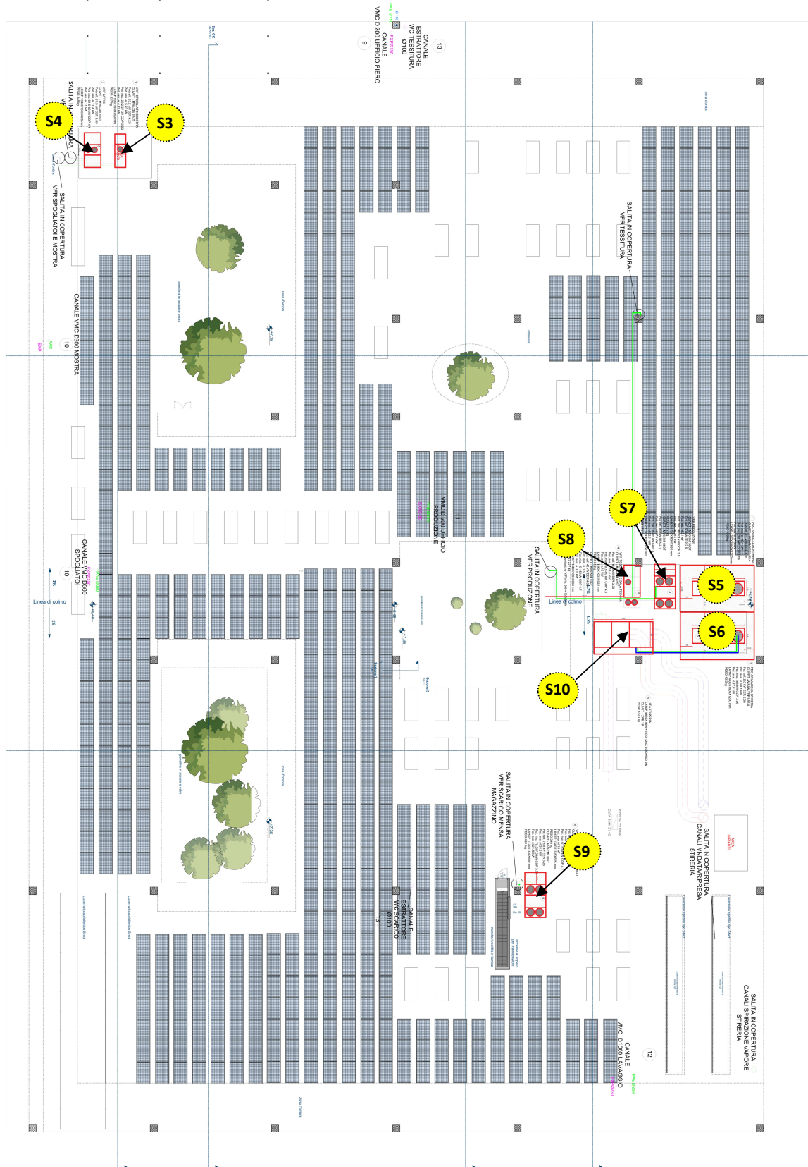
Figura 10: elaborati progettuali (layout copertura, posizione sorgenti di rumorosità)
